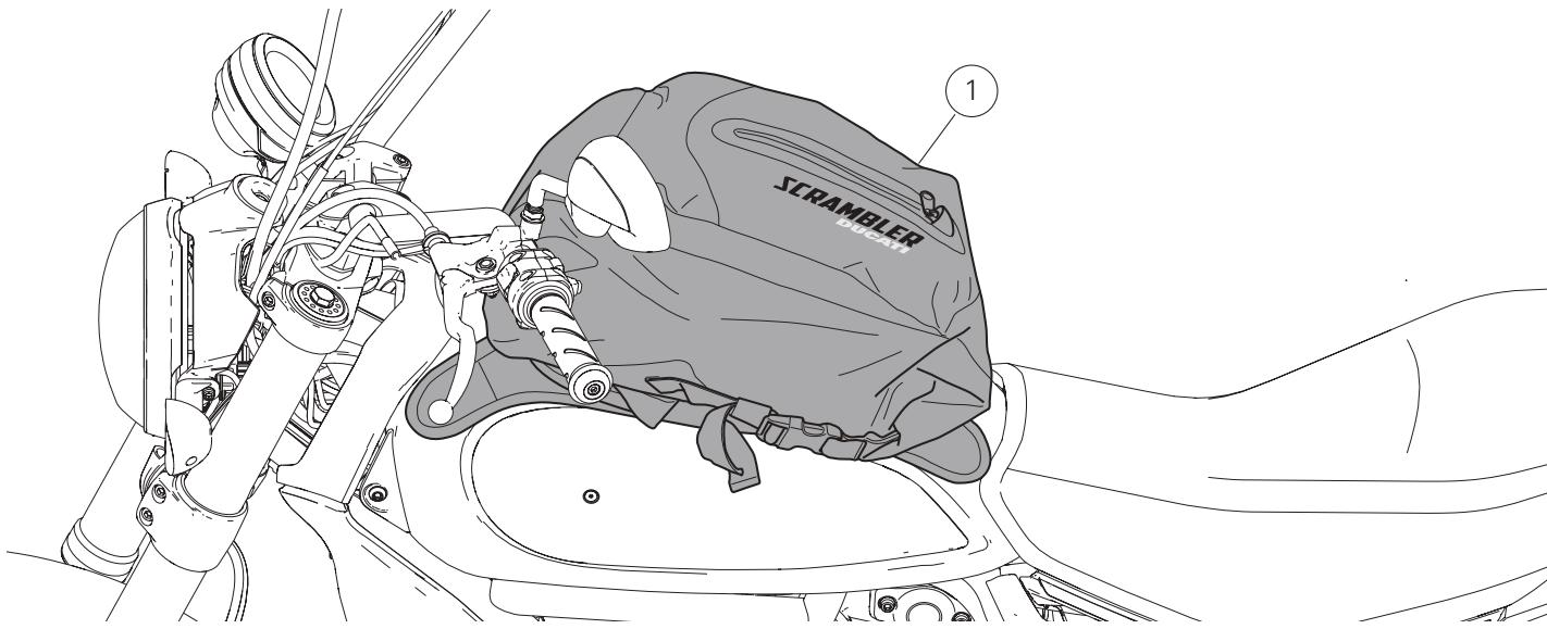
Posicionar la bolsa (1) en la motocicleta adoptando la posición de los imanes, de acuerdo con la forma del depósito, como indica la figura (X).
