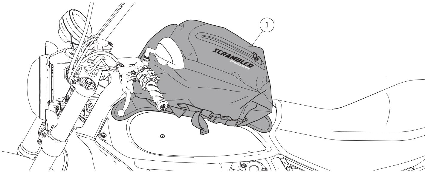
Positionner le sac (1) sur le motocycle en ajustant la position des aimants selon la forme du réservoir, comme indiqué dans la figure (X).
