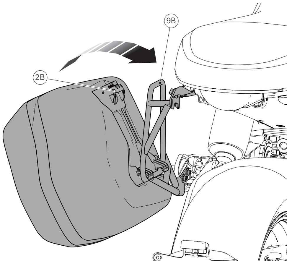
Appoggiare gli agganci inferiori (2A) della borsa sinistra (2) al supporto inferiore (9A) del telaio (9), come indicato in figura. Ruotare la chiave in posizione di sblocco dell'aggancio superiore (2B) e agganciare la borsa al supporto superiore (9B) del telaio (9).
