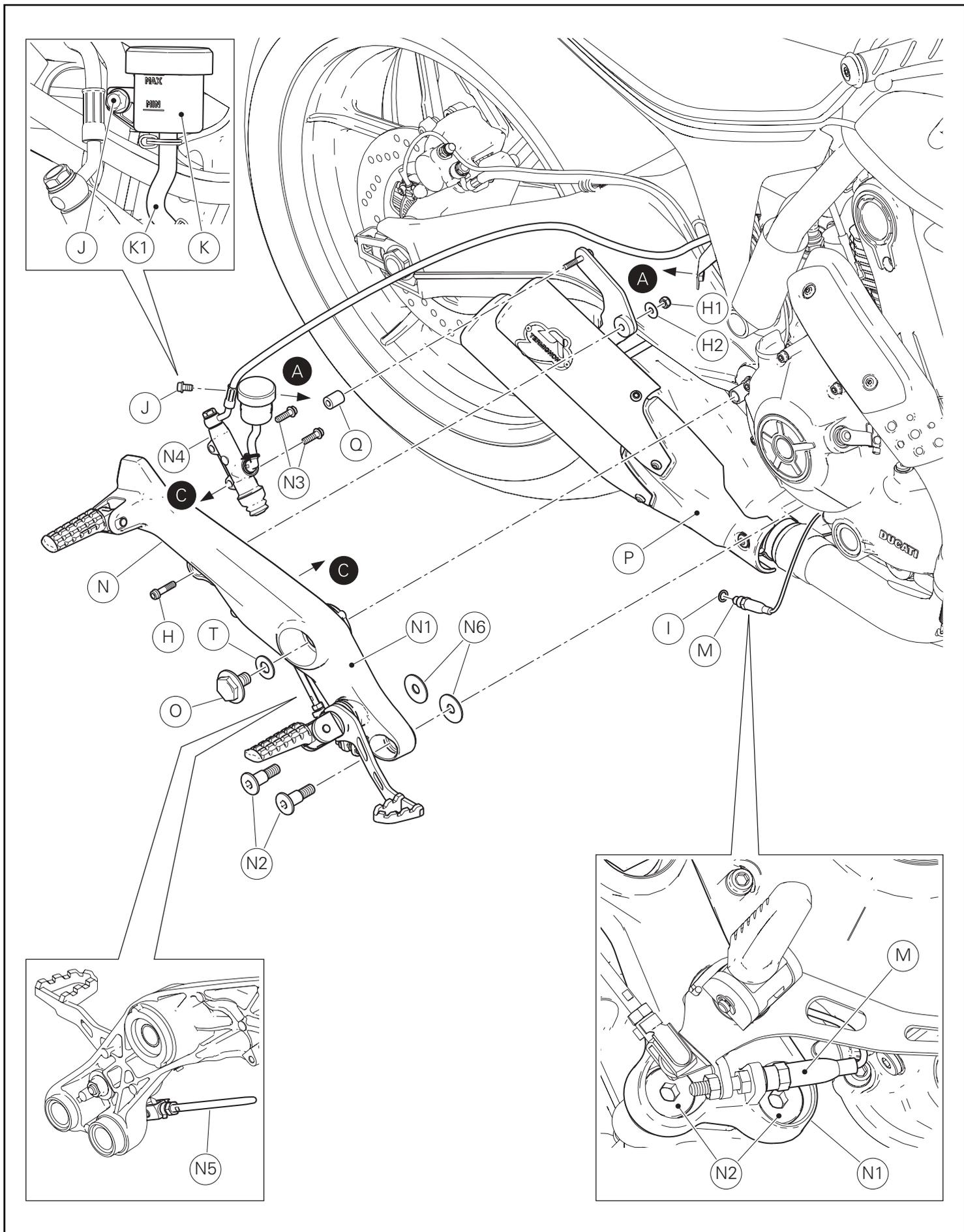
Desmontagem de componentes em motos com conjunto silenciador homologado 96480671A
