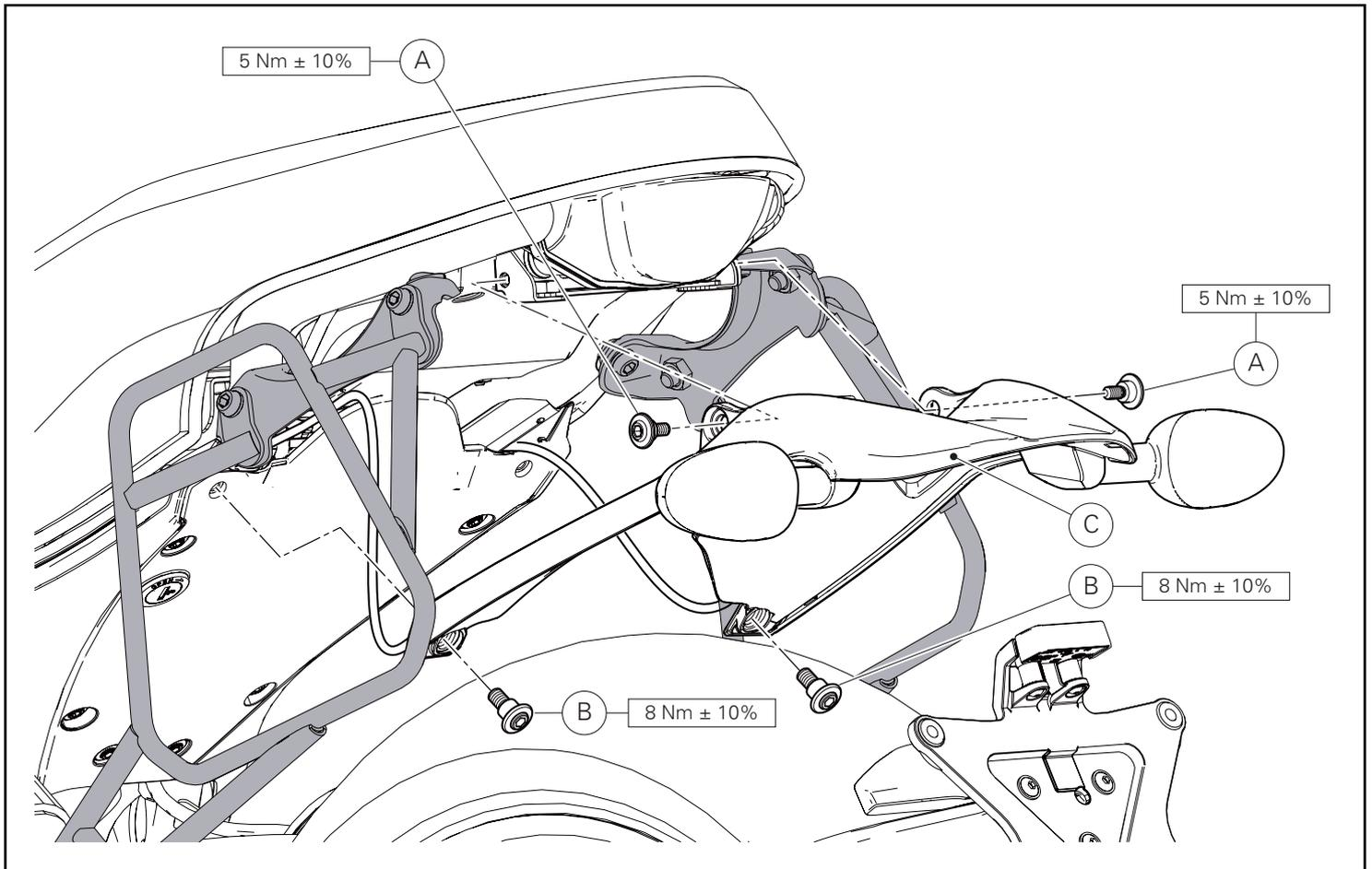
Posicionar el grupo protección trasera (C) en el bastidor e introducir los 2 tornillos superiores (A).
