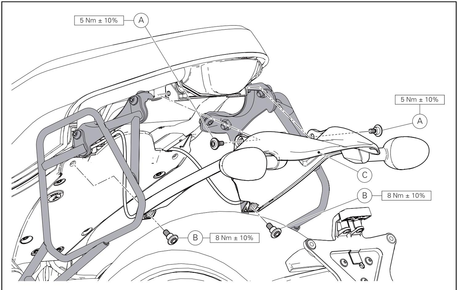
Posicione o grupo proteção traseira (C) no chassi e introduza os 2 parafusos superiores (A).
