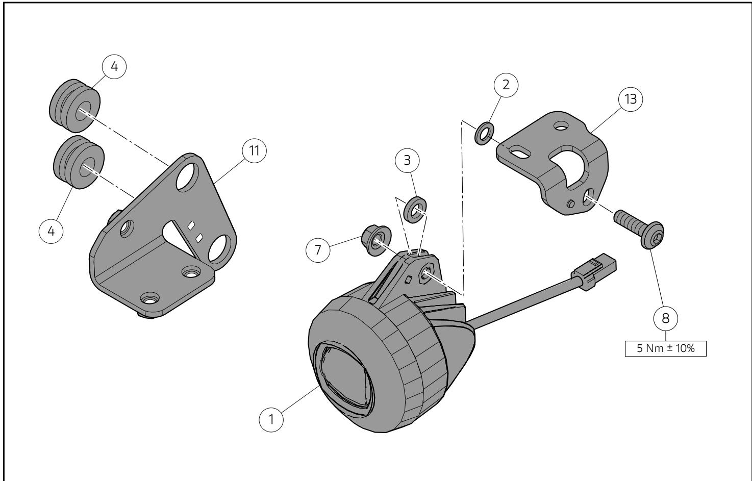
Inserire la rosetta in ottone (3) nell'apposito vano, come mostrato in figura. Accoppiare la vite (8), la staffa inferiore sinistra (13), la rosetta (2) e il faretto (1) mantenendo l'esatta sequenza rappresentata in figura. Impuntare dalla parte opposta del faretto (1) il dado (7). Serrare la vite (8) alla coppia indicata, mantenendo dal lato opposto il dado (7). Premontare sulla staffa superiore sinistra (11) i n.2 gommini (4).
