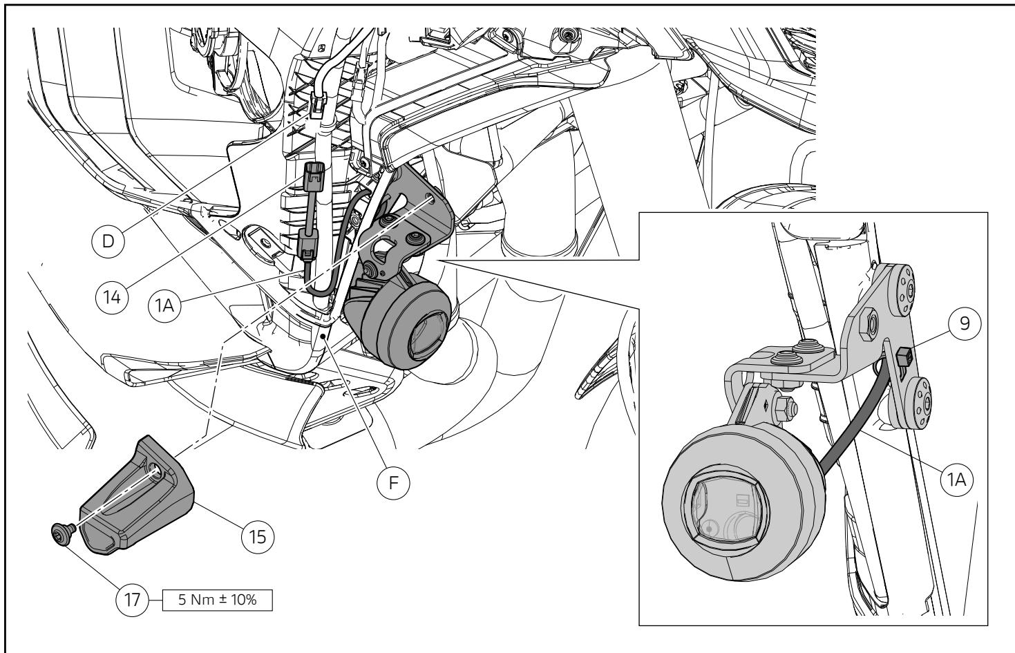
Inserire il cavo (1A) completo di prolunga (14) nell'apposita feritoia. Collegare la spina del cablaggio principale (D) alla presa della prolunga (14) e sistemare il cablaggio come rappresentato in figura all'interno della struttura (F). Fissare il cavo (1A) mediante la fascetta in nylon (9) precedentemente inserita.
