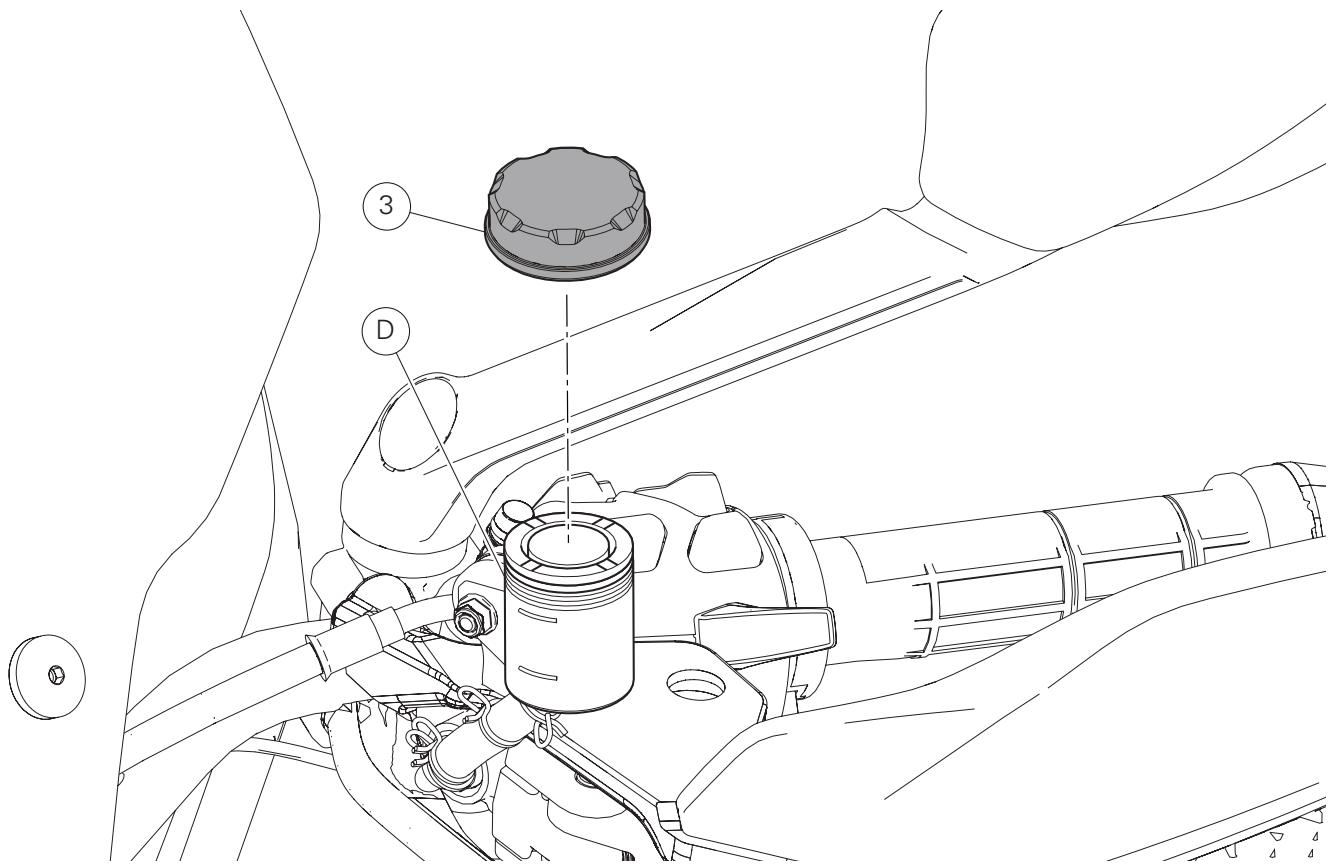
Pose bouchon réservoir d'huile d'embrayage
